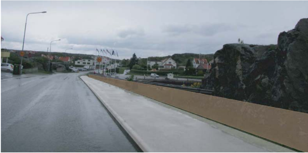
Figur 22 Principskiss av nytt trafiksäkert räcke invid gångbana som skyltas som gång- och cykelbana. Foto taget söderut på Hamngatan.
