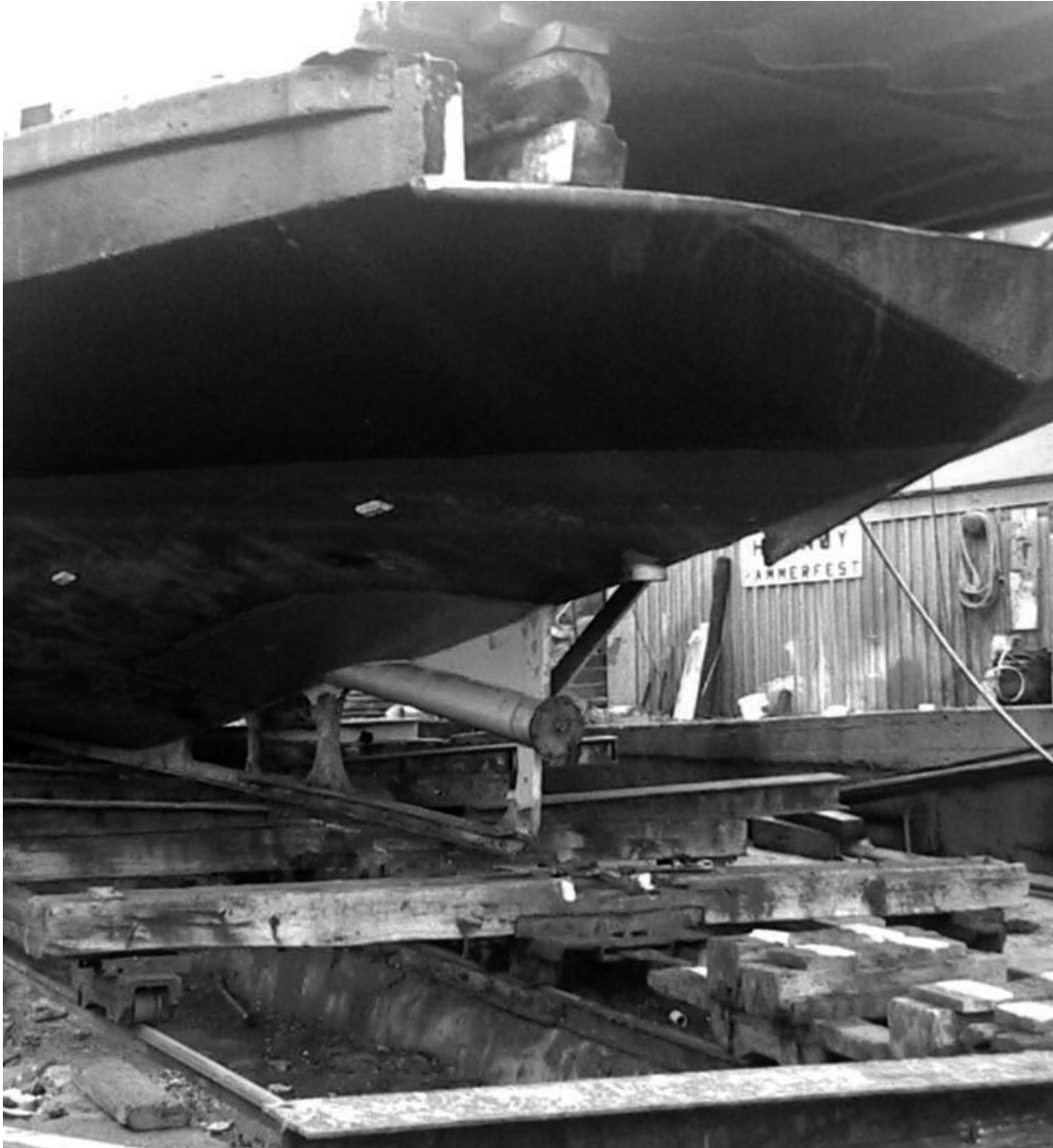
Reparentens akterparti (propelleraxelbyte) Ett typexempel där svetsfogen rensas med tryckluftdriven mejsel (knarr) Under mätningarna bearbetades emellertid däck, pällare och brädgång
