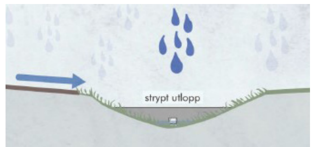
Principskiss över svackdike från dagvattenutredningen.
