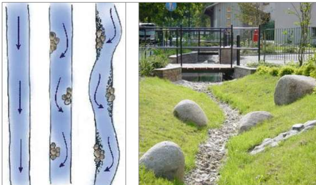
Figur 24. Genom att lägga ut stenhinder i kanterna kan man påskynda meandrering och få ett slingrande dike. Källa: http://saxan-braan.se .
